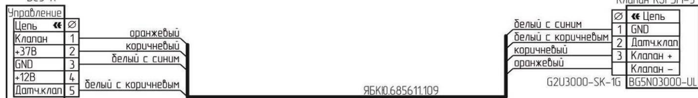
Рисунок Г.6 – Типовая схема подключения клапана К3ГЭМ-У с разъемом BG5N03000-UL
