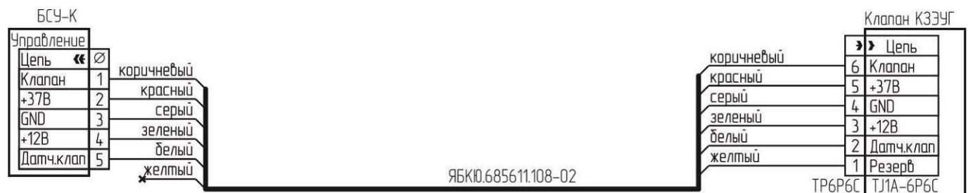
Рисунок Г.8 – Типовая схема подключения клапана К3ЭУГ с разъемом TJ1A-6P6C
